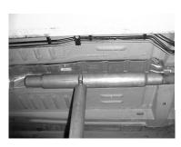
SLIP THE RESONATER #A ONTO THE FACTORY HEADPIPE. THE MUFFLER INLET IS LOOKING INTO THE LOUVERS. USE CLAMP #D TO ATTACH IT TO THE FACTORY PIPE. DO NOT TIGHTEN.
