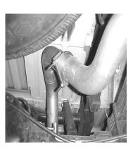
SLIP OVERAXLE TAILPIPE #D INTO THE OUTLET OF THE MUFFLER NO LESS THAN 1 ½" AND NO MORE THAN 2". ATTACH CLAMP #F AT THE MUFFLER OUTLET (**DO NOT TIGHTEN**). INSERT WELDED HANGER INTO RUBBER GROMMET.
