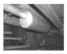
NEXT CONNECT THE MUFFLER TO THE HEADPIPE USING CLAMP # F. USE JACKSTAND TO SUPPORT THE MUFFLER. THE OUTLET OF THE MUFFLER WILL BE AT APPROXIMATELY 10 O'CLOCK. THE MUFFLER INLET IS LOOKING INTO THE LOUVERS.
