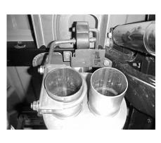
INSTALL HANGER #F AT THE OUTLET OF THE MUFFLER ON DRIVERSIDE. INSERT WELDED HANGER INTO RUBBER GROMMET. DO NOT TIGHTEN CLAMP.
