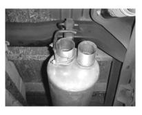
INSTALL MUFFLER #C. THE INLET OF THE MUFFLER WILL HAVE THE OPEN LOUVERS FACING FORWARD GRABBING THE EXHAUST. MAKE SURE THE MUFFLER OUTLETS ARE POSITIONED AT THE TOP OF THE MUFFLER. INSTALL HANGER #H ON THE DRIVER SIDE OUTLET OF THE MUFFLER OUTLET ON DRIVERSIDE. DO NOT TIGHTEN.
