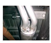
NEXT INSTALL MUFFLER #C. SLIDE IT ONTO HEADPIPE 1-1/2" TO 2". INLET OF MUFFLER SHOULD FACE TOWARDS THE MOTOR. INSTALL REAR MUFFLER HANGER #J INTO RUBBER GROMMET LOCATED JUST ABOVE THE DRIVERS SIDE OUTLET OF THE MUFFLER. SLIDE CLAMP ONTO MUFFLER OUTLET. INLET OF MUFFLER IS LOOKING INTO THE LOUVERS. DO NOT TIGHTEN.
