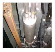
INSTALL MUFFLER # B ONTO HEADPIPE 1 ½" TO 2". USE A JACK STAND TO HOLD UP THE MUFFLER. OUTLETS SHOULD BE ON THE TOP.
