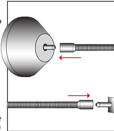
Las terminaciones de la líneas vienen instaladas en la línea de la aspiradora. No se necesitan remover a menos que se necesiten cortar. Instale la línea al avance de la aspiradora en su lugar. Guíe la línea a la entrada de la aspiradora en el carburador. Si es necesario cortar remueva la cubierta jalándola de la línea, haga el corte y reinstale (asegúrese que la línea esté libre de cualquier partícula ó rebaba). La línea puede después ser presionada a la entrada de la aspiradora.
