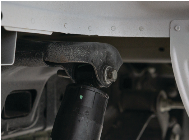
Fig. 19: Remove upper shock mount bolt.
