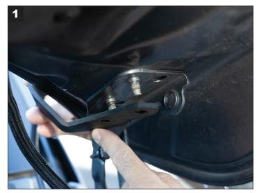
IDENTIFY DRIVER & PASSENGER SIDE BRACKETS AND MAKE SURE TO INSTALL ONE SIDE AT A TIME TO ENSURE HOOD ALIGNMENT. WITH THE HOOD UP, BEGIN BY MANEUVER THE DITCH MOUNT BRACKETS INTO POSITION 'OVER' THE FACTORY HINGE & STUDS.
