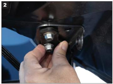
SEAT THE BRACKET FLAT AGAINST THE FACTORY HINGE PLATE & STUDS - THE BRACKET WILL CLICK INTO PLACE TO INDICATE CORRECT ALIGNMENT.
