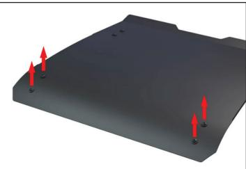
LOCATE AND REMOVE THE FRONT 4X M6 TORX TRUSS SCREWS AND WASHERS.
