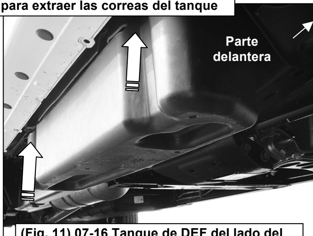
(Fig. 11) 07-16 Tanque de DEF del lado del pasajero y cubierta
