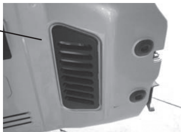
Cubierta de inspección
